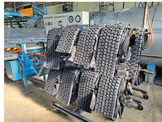
Neue Laufflächen warten darauf, mit einer vorbereiteten Karkasse im Ofen quasi zu verschmelzen.
