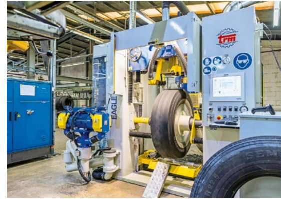
Die Abraummaschine macht auf der Karkasse den Weg frei für die Runderneuerung.
