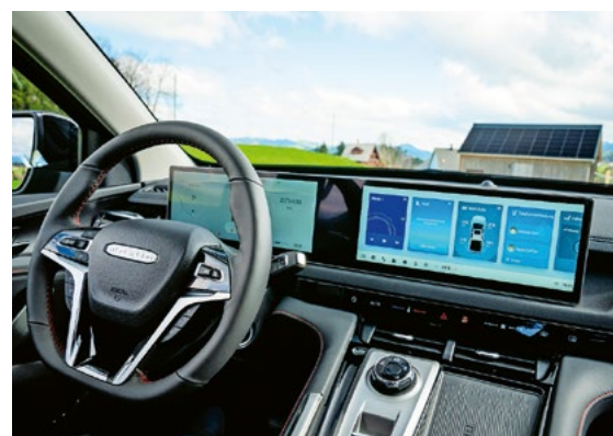
Auch im T60 Max findet sich das duale 12,3-Zoll-Display mit digitalem Tacho und 360°-Kamerasystem.
