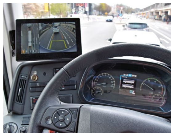
Das Multifunktionslenkrad gibt es im Safety Coach seit 2013, die MirrorCam optional seit 2023.
