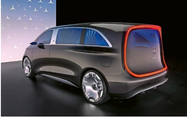
Die grosse Heckscheibe ist umrandet von über 450 leuchtenden Lamellen als Rück- und Bremslicht.
