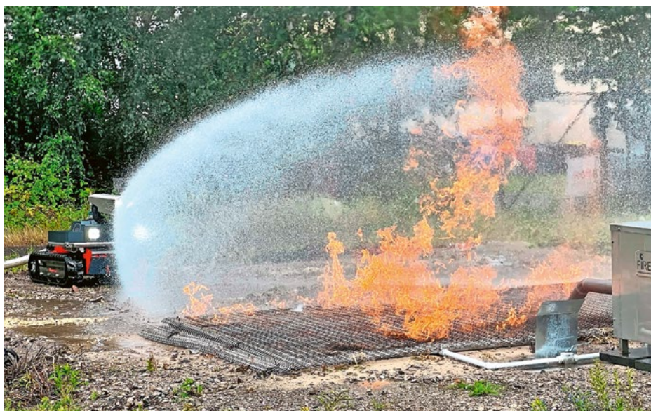
Utilisation du robot RTE multifonctionnel pour la lutte contre l'incendie sur le terrain d'essai du DRZ.
